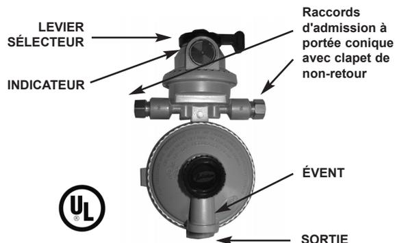
Le régulateur automatique à levier sélecteur Fairview Fittings dirige automatiquement le débit de gaz de pétrole liquéfié (GPL) de la bouteille de service vide désignée à la bouteille de réserve, sans interruption de service. Il est idéal pour les véhicules de plaisance (RV), les petits chalets et les camps de villégiature.
